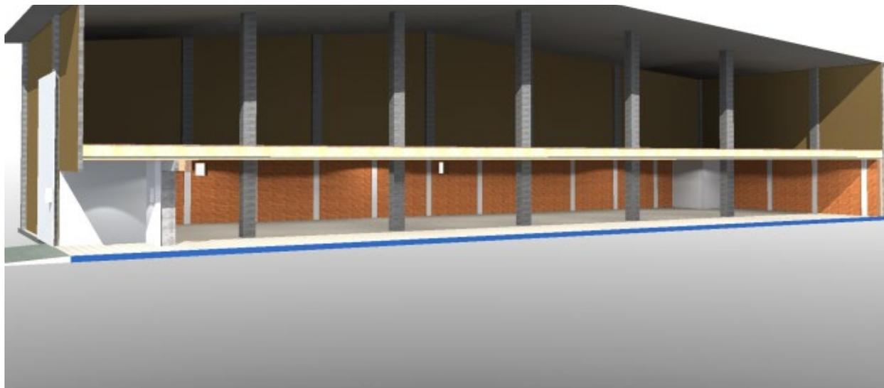
Dibujo arquitectónico del almacén ecológico que muestra el cielo falso doble y las segundas paredes. © CICR, 2020
