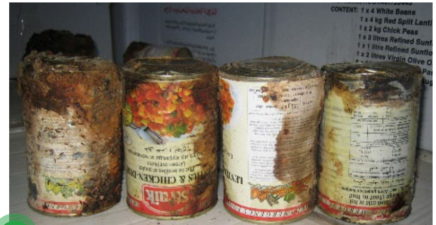
Existencias dañadas debido a malas condiciones de almacenamiento
